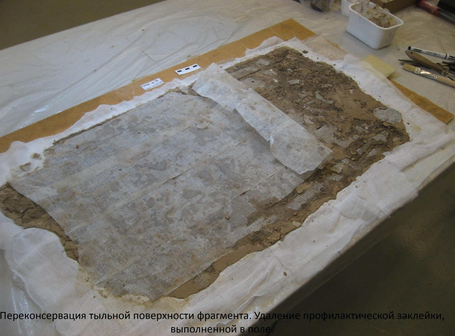
Переконсервация тыльной поверхности фрагмента. Удаление профилактической заклейки, выполненной в поле.
